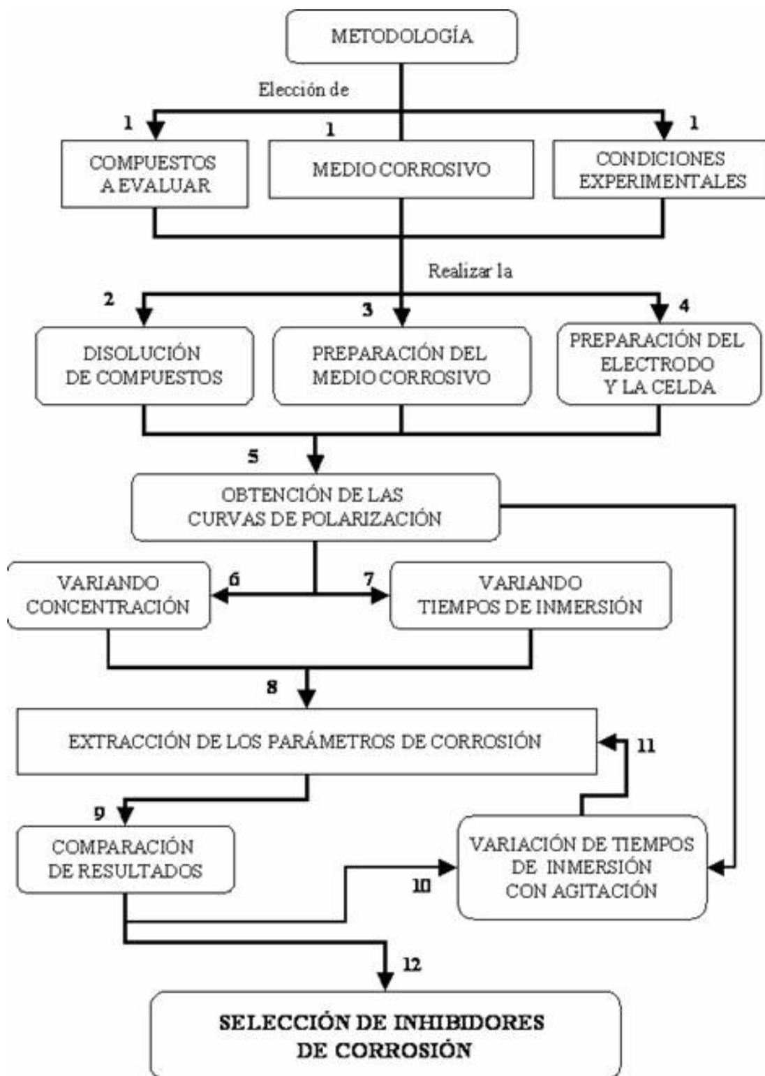
**Figura IV.1** Metodología que se empleó para la selección de los diferentes compuestos orgánicos con características de inhibición a la corrosión.
